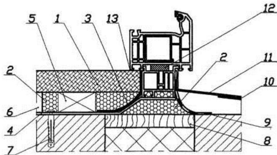
**Рис.2. Узел нижнего примыкания оконного блока, подоконника и слива к проему слоистой стены с эффективным утеплителем:**
