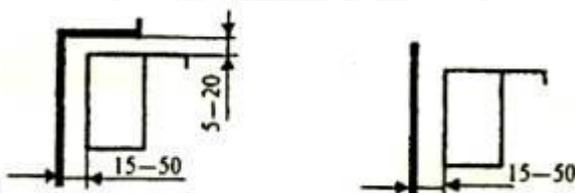
а) оконные блоки из алюминиевых сплавов при размере стороны до 200 мм
