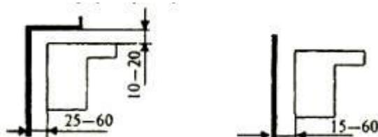
в) оконные блоки из ПВХ профилей белого цвета при размере стороны от 2000 мм до 3500 мм, а также из профилей других цветов при размере стороны до 2000 мм
