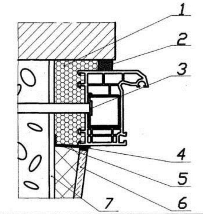
**Рис.3. Узел бокового примыкания оконного блока к проему с четвертью в стене из ячеистобетонных блоков (плотностью 400 - 450 кг/м<sup>3</sup>) с облицовкой кирпичом и отделкой внутреннего откоса панелью.**
