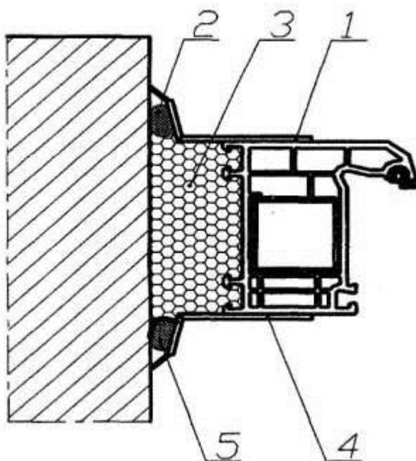
**Рис. 6. Узел изоляции и отделки оконного стыка за одну рабочую операцию (планки установлены с наружной или внутренней сторон стыка):**
